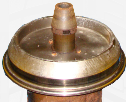
磨损的 D70 机器主轴和轮辋
